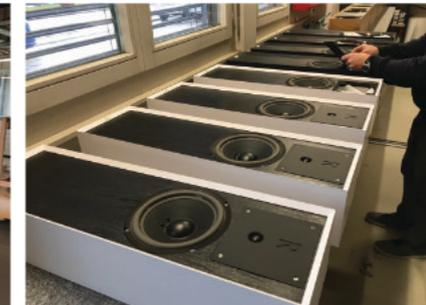
Eine grosse Investition und in Europa nur ganz selten anzutreffen ist die CNC Maschine mit automatisierter Kantenbelegung auf 45 Grad. In Kombination mit der eigenen Steuerungssoftware ermöglicht dies sehr effiziente Durchläufe der Produktion für Möbel auf Mass. Mit viel Know-how und grösster Sorgfalt werden die Möbel und Lautsprecher von Hand zusammengebaut. Teile wie Griffe, Füsse, Stoff-Rahmen, Verstrebungen aller Art und Verstärkergehäuse werden allesamt in der Schweiz produziert.
